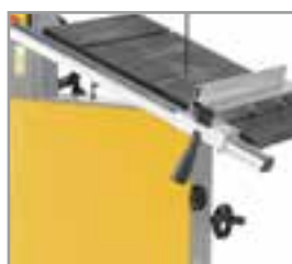
Altezza massima di taglio fino a 224 mm Hauteur max de coupe jusqu'à 224 mm
