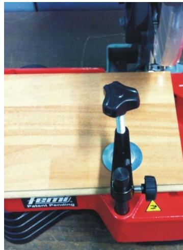
IT - per il bloccaggio del pezzo può essere utilizzato il morsetto verticale come mostrato in figura;
