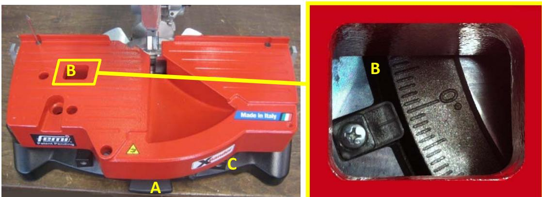
IT - Per l'esecuzione di tagli inclinati: premere il pulsante di blocco A; ruotare l'unità di taglio leggendo l'angolo impostato nella fessura B; stringere il pomello C.
