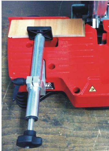
IT - per il bloccaggio del pezzo può essere utilizzato il morsetto orizzontale come mostrato in figura;
