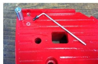
**IT** - Rimuovere entrambe i perni indicati in figura utilizzando la chiave a brugola in dotazione;
