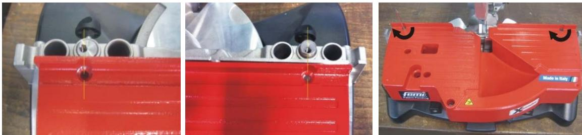
IT - Inserire i perni nella base d'appoggio della macchina allineati con i fori dell'X-pander e bloccarli con i pomelli forniti in dotazione. Appoggiare l'X-pander sui perni e stringere le viti come indicato in figura;
